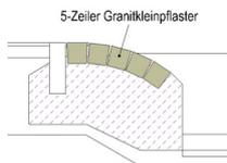
Bettung in Beton C 12/16, Dicke 30 cm, mit einseitiger Rückenstütze, eng verlegt, im Abstand von etwa 8 m durchgehende Bewegungsfugen in Betonbettung durch Trennschichten aus Bitumenpappe o. bitumenimprägnierten PUR-Schaumstoff.
