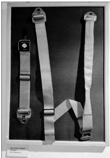
**Auto-Sicherheitsgurt „Döblina“ mit Schlauchteil** und stellt die Produktion der Auto-Sicherheitsgurte auf diese Ausführung um. Die Entwicklung wurde hier mit dem Institut für Technologie der Fasern, der Deutschen Akademie der Wissenschaften zu Berlin betrieben.
